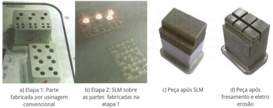
Figura 6: Etapas da fabricação dos insertos
