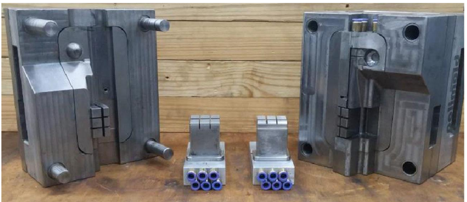
Molde com os inserts intercambiáveis – refrigeração convencional e refrigeração conformada
